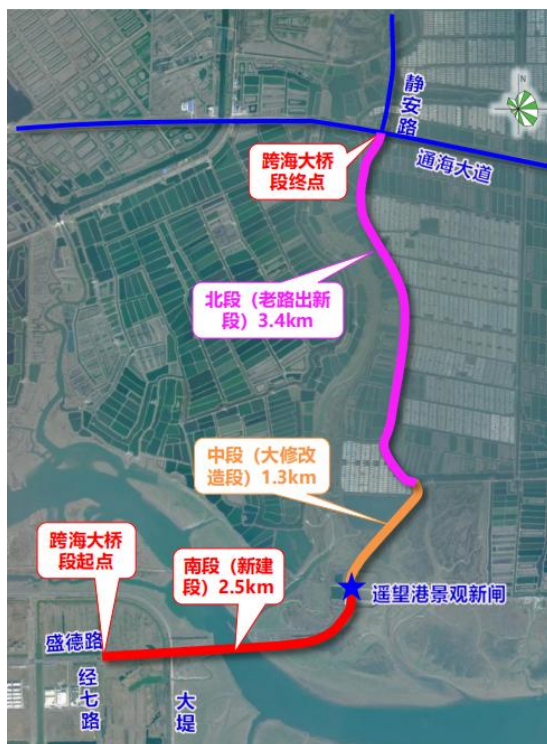
图 2.1-2 跨海大桥段路线方案示意图
