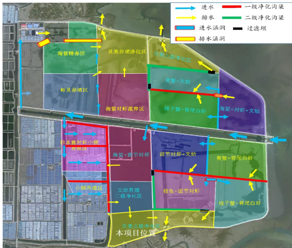
图 1-3 养殖区进排水系设计图
