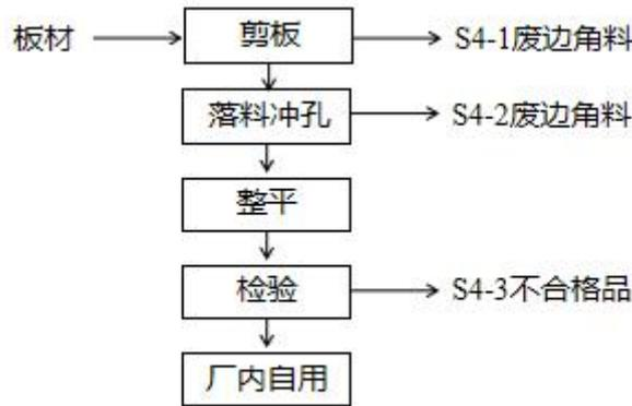
图 2-5 法兰生产流程及产污节点图
