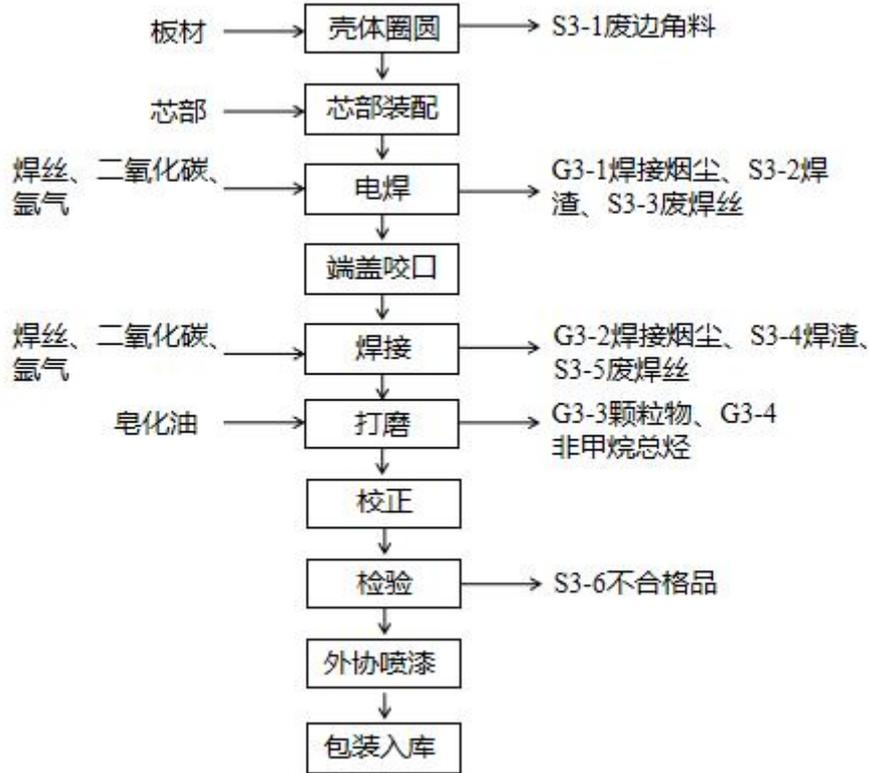
图 2-4 消声器生产流程及产污节点图
