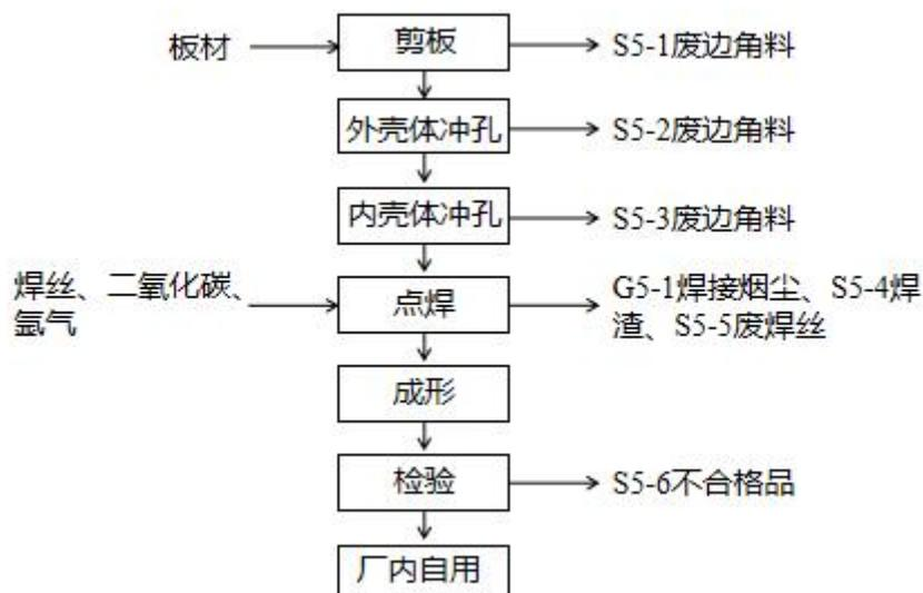
图 2-6 壳体生产流程及产污节点图
