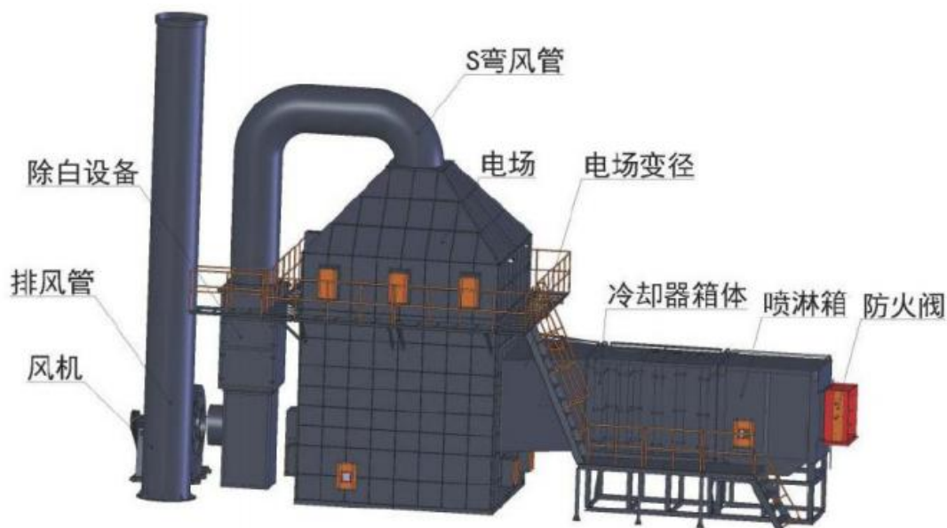
图 6.2-4 “水喷淋+静电净化”设备示意图
