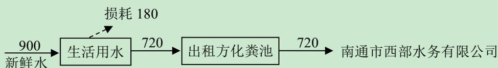
图 3.5-1 项目水平衡图 单位：t/a
